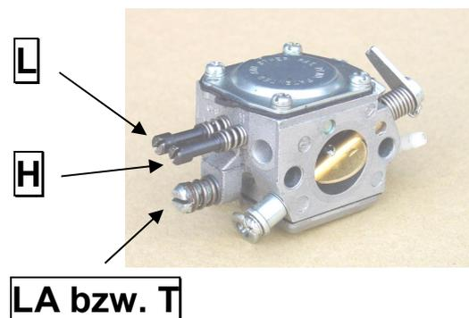
Beim Herausdrehen der L- oder H-Schraube wird das Kraftstoff-Luft-Gemisch fetter, beim Hineindreihen magerer!
